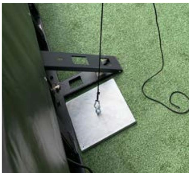
Stahlplatte zur Netzbescherung
