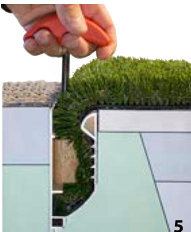
5 Nach der Einführung bis zum Arretierungssteg wird das Element um 90° gedreht. Anschließend wird der Einbauschlüssel angehoben. Die Fixation, welche im Abstand von ca. 50 cm vorgenommen wird, gewährleistet, dass der Kunstrasen den Zugkräften standhält.
