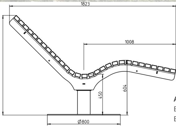
**Ausführung:** mobil mit Bodenrunde, mit Befestigungsbohrungen
